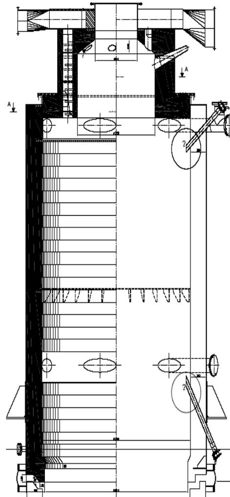
**Ausgemauerte Brennkammer in stehender Ausführung**
